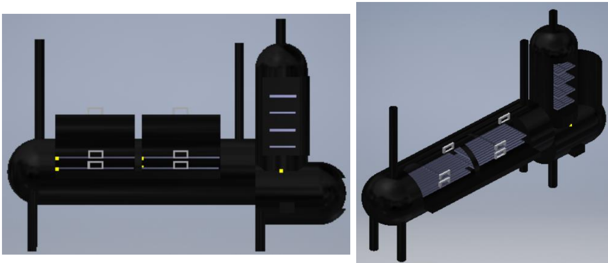
Figura 14: Plano 3D smoker grill Fuente: elaboración propia
