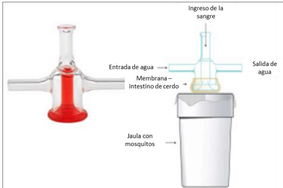
Figura 6. Sistema de alimentación artificial para el mantenimiento de mosquitos (Caicedo, 2008).
