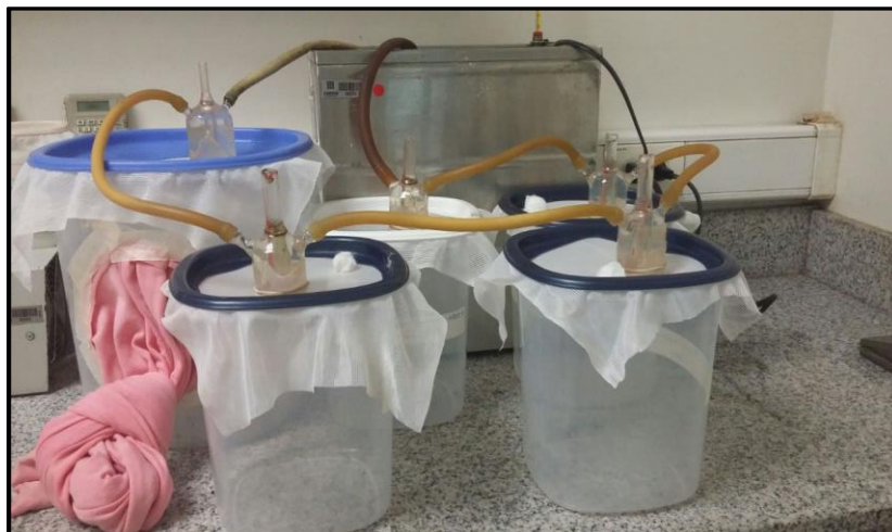
Figura 10. Alimentación artificial en cepas de Aedes aegypti a través de alimentadores de vidrio
