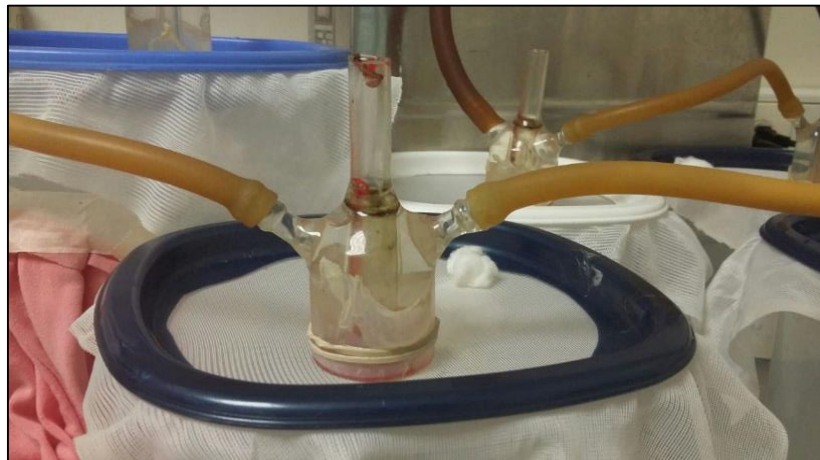
Figura 9. Alimentador de vidrio cubierto con intestino de cerdo como membrana para la alimentación de mosquitos.
