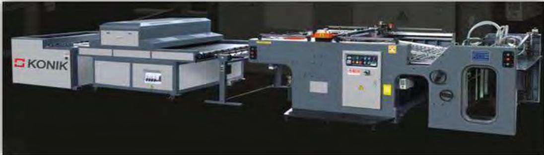
En términos generales, la maquina tiene una potencia de 10.22kw, pesa 3,8 toneladas, el tamaño mínimo de papel con el que trabaja es de 350 x 270mm y el máximo es de 780 x 540mm, su máxima velocidad de impresión es de 1000-3300 sph, y sus dimensiones son 4100 x 2080 x 1270 mm.
