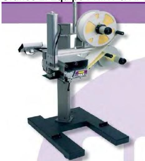
Con el uso de este equipo se garantiza un efectivo proceso de impresión y aplicación de la etiqueta sobre los empaques de polietileno termoencogible y corrugados, cuentan con un sistema de disparo de etiqueta soportado en chorro de aire, que asegura la adherencia total de la etiqueta.
