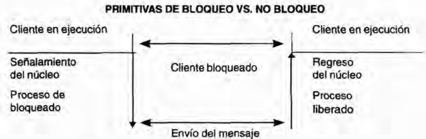
Figura 2.8. Una primitiva senda con bloqueo.
