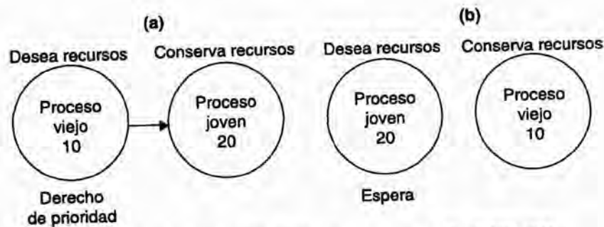
Figura 3.9. Algoritmo herida-muerte para la prevención de bloqueos.
