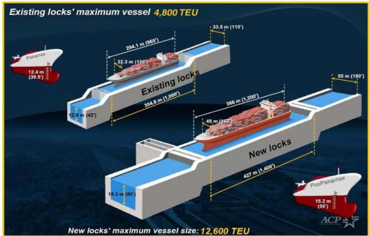
Figura 11: Características de naves portacontenedores que pueden pasar por las nuevas esclusas del Canal de Panamá
