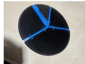
1.3 Prototipo producido en PLA y TPU, validación materiales y forma de la superficie del balancín origami.
