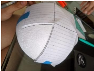
1.9 Media esfera de poliestireno expandido como modelo para evaluación de funcionamiento del accesorio o periférico.
