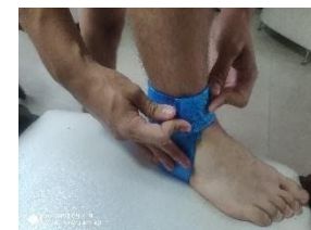
1.6 Prototipo de tobillera, en impresión 3d TPU, validación del material y forma del producto.
