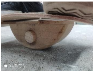
2.0 Esfera inferior en MDF, validación forma y resistencia.
