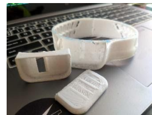
1.4 Impresión de prototipo de ortesis en TPU y del componente electrónico en PLA para validación de forma, material y comunicación de función.
