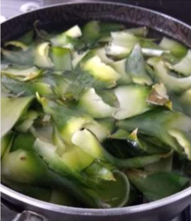
Imagen 28. Chilito, L (2019). Proceso de cocción de la hoja de piña cortada para la deslignificación posterior a 80°C.
