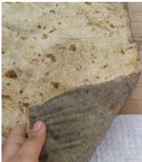
Imagen 32. Chilito, L. (2019). Obtención final del papel de piña, luego de los procesos de paso por el cedazo y secado.
