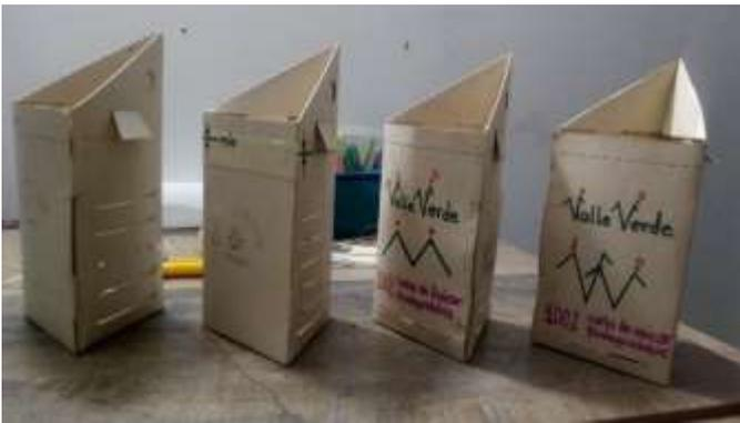
Imagen 36. Chilito, L. (2019). Propuesta del primer prototipo con marca y logo para los empaques, con la incursión de las franjas de rasgado para la salida del sistema radicular en el lugar de trasplante.
