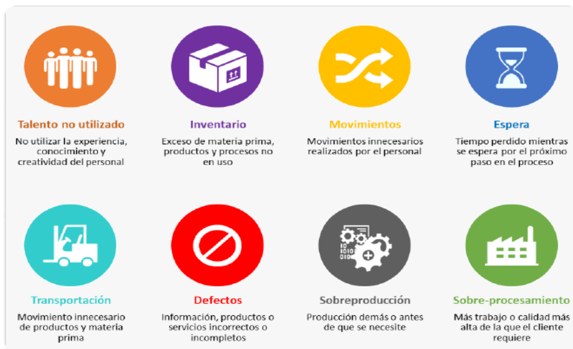
Figura 5. Tipo de desperdicios definidos por el sistema Lean Manufacturing. Fuente: Internet http://www.practicorte.com/interno.html
