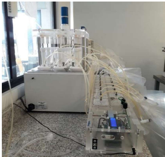
Figura 5. Montaje experimental para la producción de biogás
