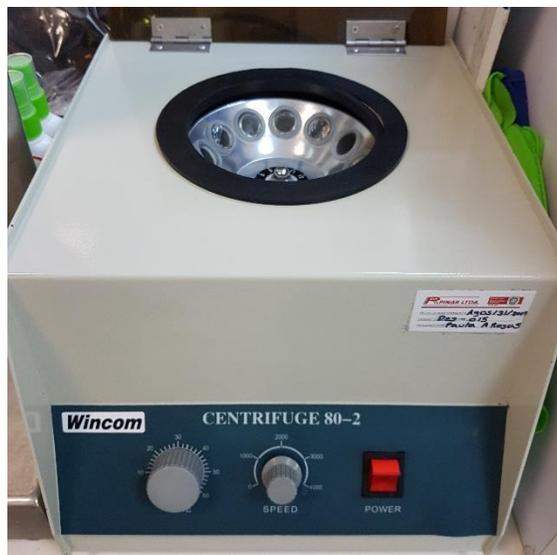
*Figura 11. Centrífuga utilizada en las pruebas de sedimentación*
