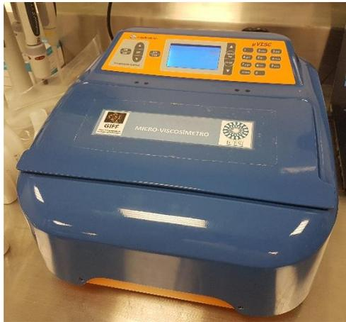
*Figura 10. Microviscosímetro utilizado para las mediciones del perfil reológico*
