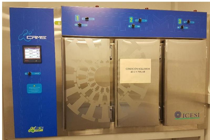
*Figura 12. Cámara de estabilidad acelerada*
