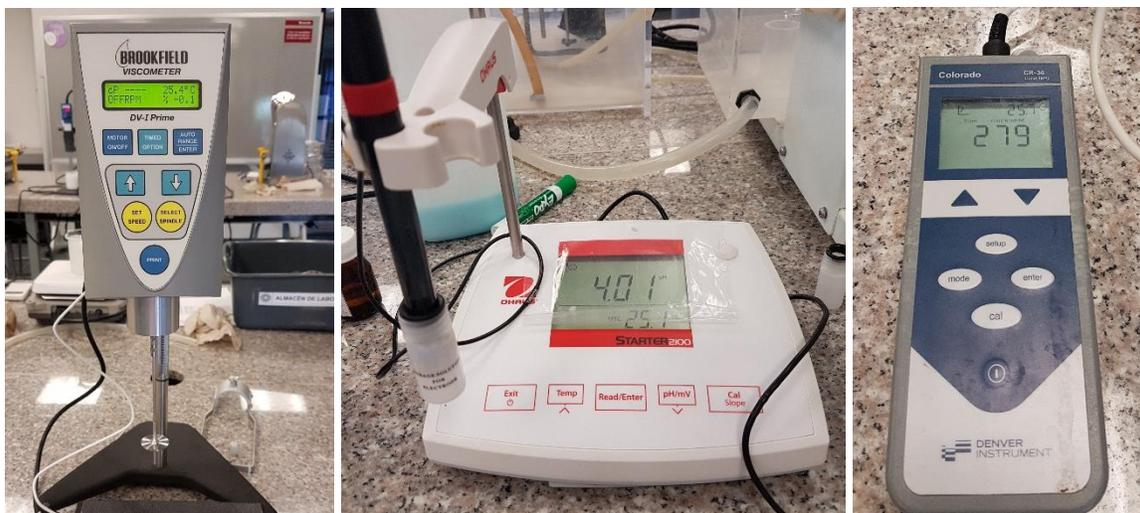
*Figura 7. Equipos utilizados en las mediciones de viscosidad (izquierda), pH (centro) y conductividad (derecha) de las emulsiones O/W fabricadas*
