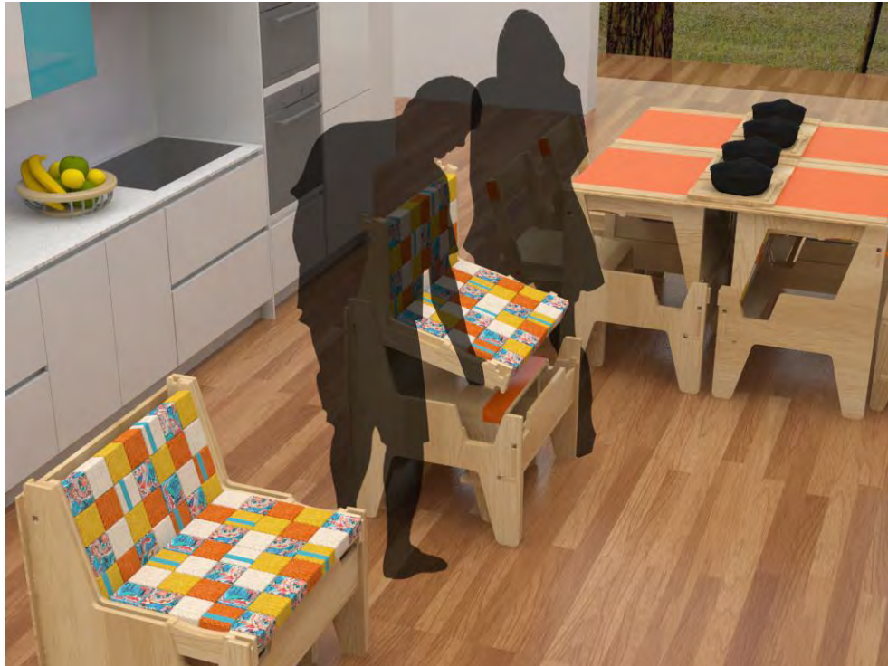
Ilustración 417. Transformación del módulo A, de sofá a mesa. Fuente: Cáceres, J. y Gómez, D. (2015).
