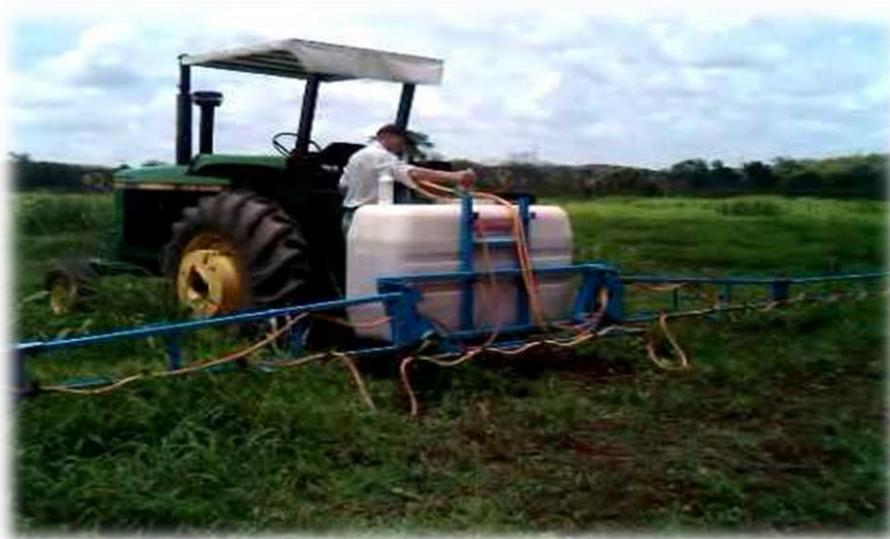
Las boquillas que se utilizan para la aplicación de herbicidas son boquillas Teejet 150-04 (150 grados de salida, 0.4 galones por minuto) para un total de fertilizante aplicado de 12 galones por hectárea.
