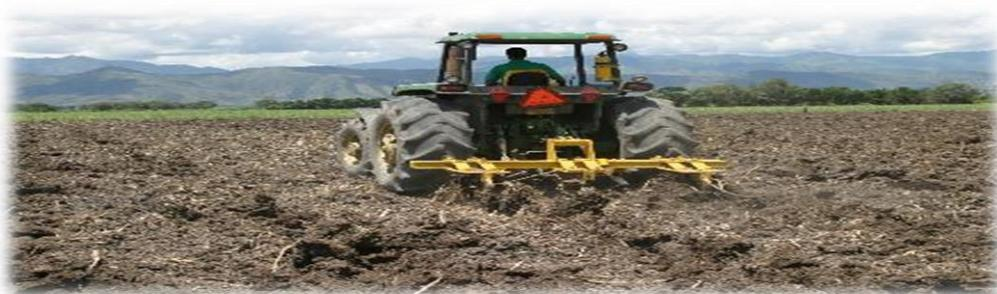
Esta labor inicio a las 11:19 AM y finalizo a las 1:03 PM con una temperatura de 34,9 grados centígrados para una duración total de 1 hora y 43 minutos con un consumo de ACPM de 6 galones por hora al realizar una regla de tres se determina que el consumo de gasolina total para la duración total del proceso es de 10,3 galones , durante todo el recorrido el conductor mantuvo una velocidad constante de 8, 4 KM cuando el camión se desplaza en línea recta y unas
