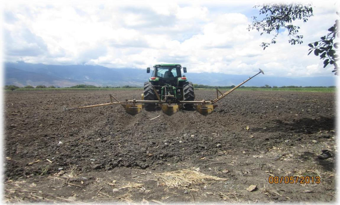
Esta labor inicio a las 1:55pm y finalizo a las 2:22 pm con una temperatura inicial de 32,1°C y una temperatura final de 32,7°C para una duración total de 27 minutos con un consumo de ACPM de 8 galones por hora para un total de 3,6 galones, durante todo el recorrido el conductor mantuvo una velocidad constante de 11,2 Km/h y unas revoluciones por minuto de 2200. Se realizó una pasada.
