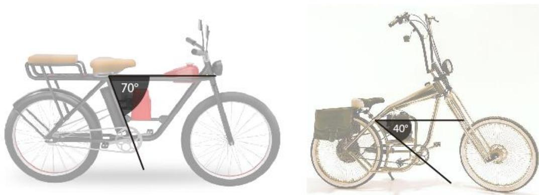
Ilustración 13. Paralelo ergonómico de ángulos de pedaleo de BICLO
