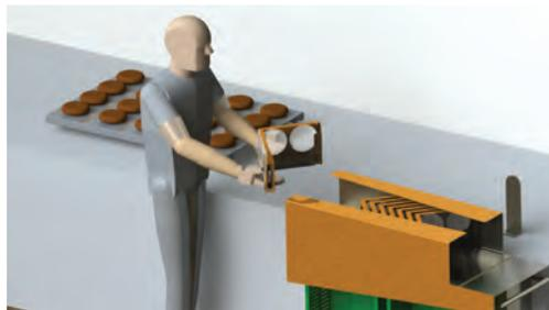
**7** Cuando termina de desmoldar, el operario introduce los moldes vacíos al módulo de almacenaje, y nuevamente comienza su proceso
