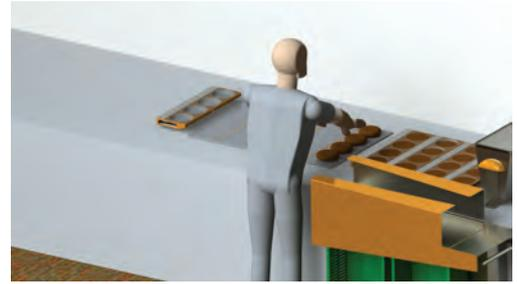
**6** El operario debe desmoldar las panelas sobre la superficie de secado, la cual se mueve a lo largo de la mesa y es recibida posteriormente por el operario que las lleva a empaque
