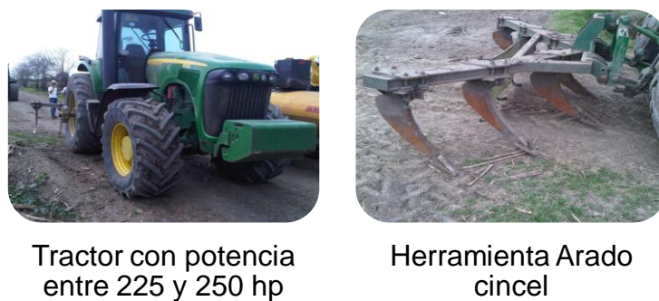
Figura 6. Maquinaria y equipo para realizar proceso de cincel
