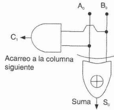
Figura 4 Circuito sumador para los dígitos menos significantes de dos números binarios.
