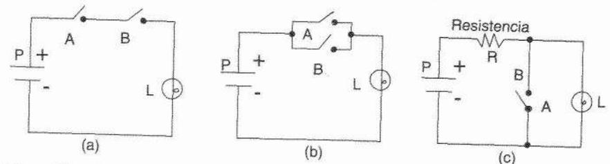
Figura N° 2 (a) ilustra un circuito que muestra la función lógica *y*; 2(b) muestra la función lógica *o*; (c) ilustra la función *negación* (la resistencia  $R$  limita la descarga de la pila).
